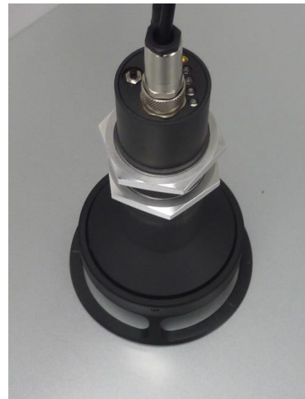
Nasadka Offline do pomiarów laboratoryjnych
